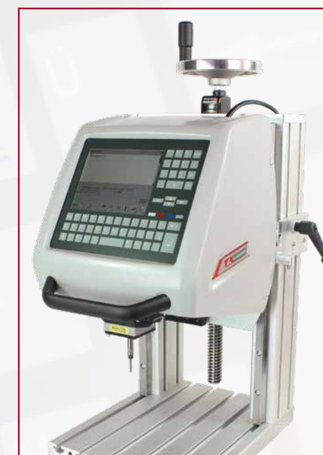
Stupni stolni nosač s ručnim kotačem (opcija)
